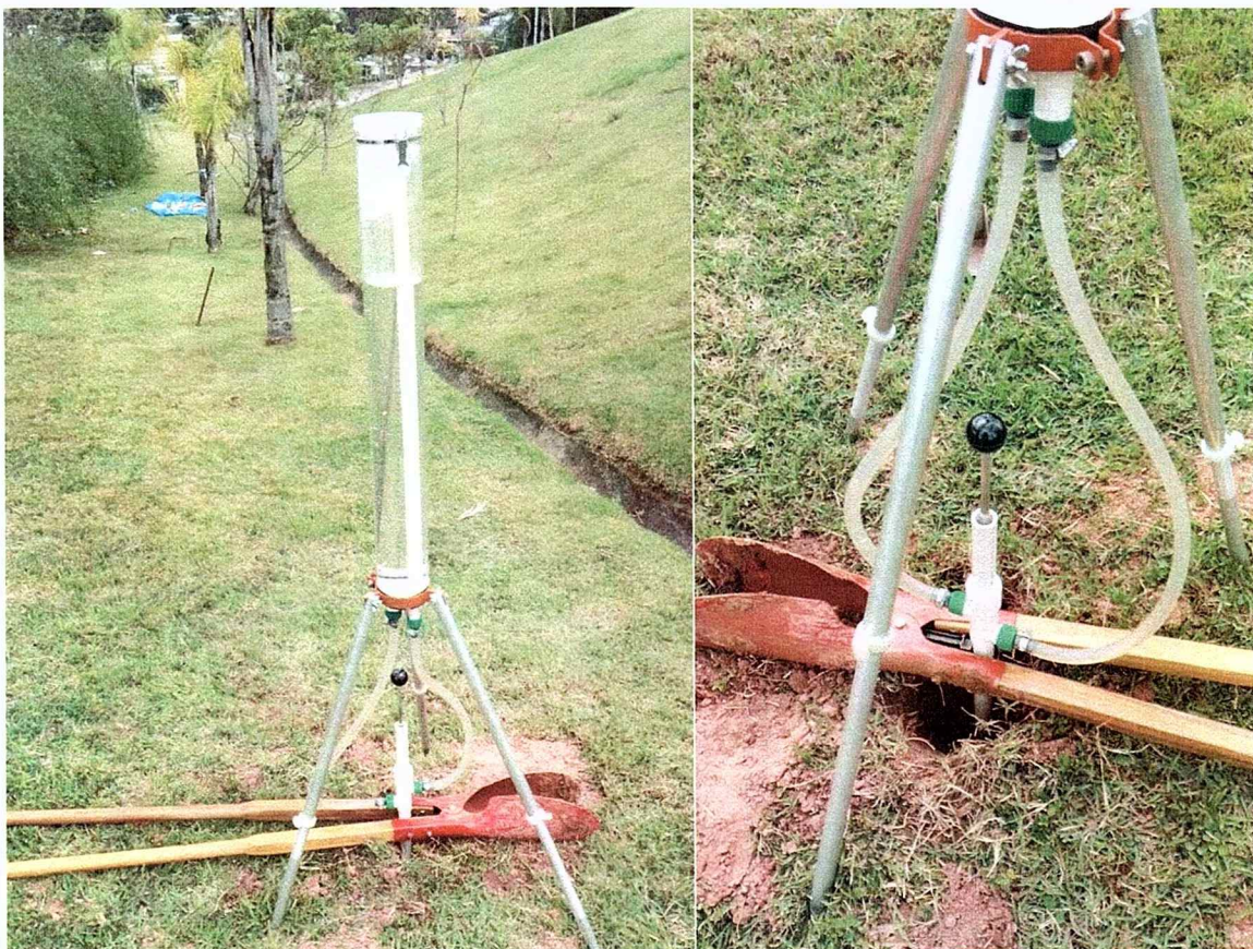
Figura 15 (a) Permeâmetro de Guelph utilizado no ensaio (b) Zoom das mangueiras conectoras e válvula graduada para a escolha da carga (H) utilizada. Furo de 30 cm.
